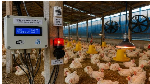
Gambar 2 2Sistem Monitoring dan Kontrol Kandang Ayam
