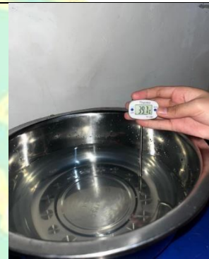
Dokumentasi suhu air perbandingan Setelah di Campurkan 8 Gelas air dengan suhu 27,9°C dan 2 Gelas air dengan suhu 92,9°C . Maka hasil jumlah suhu air dari kombinasi tersebut yaitu 39,7°C
