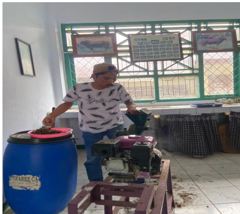
Gambar 7 : proses penggilingan Eceng Gondok yang sudah di keringkan
