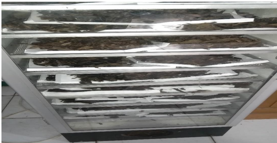
4.pembukaan gentong fermentasi dan proses pengeringan eceng gondok dengan menggunakan oven
