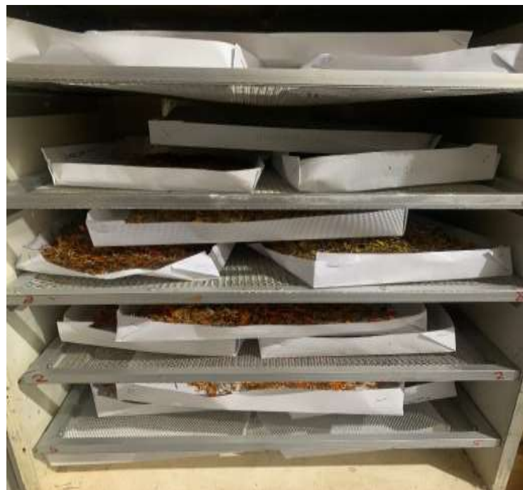
Gambar 6. Mesin pengering bunga marigold dan marigold yang siap dikeringkan
